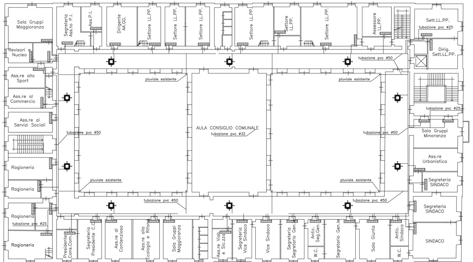
PIANTA PIANO PRIMO POSIZIONAMENTO SCARICHI DI CONDENSA
